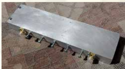
Figura 4. Filtro di frequenza, centrato sui 1666 MHz con ampiezza approssimativa di 25 MHz, che sarà usato per l'osservazione delle linee ai 1665 MHz e 1667MHz dell' OH.
